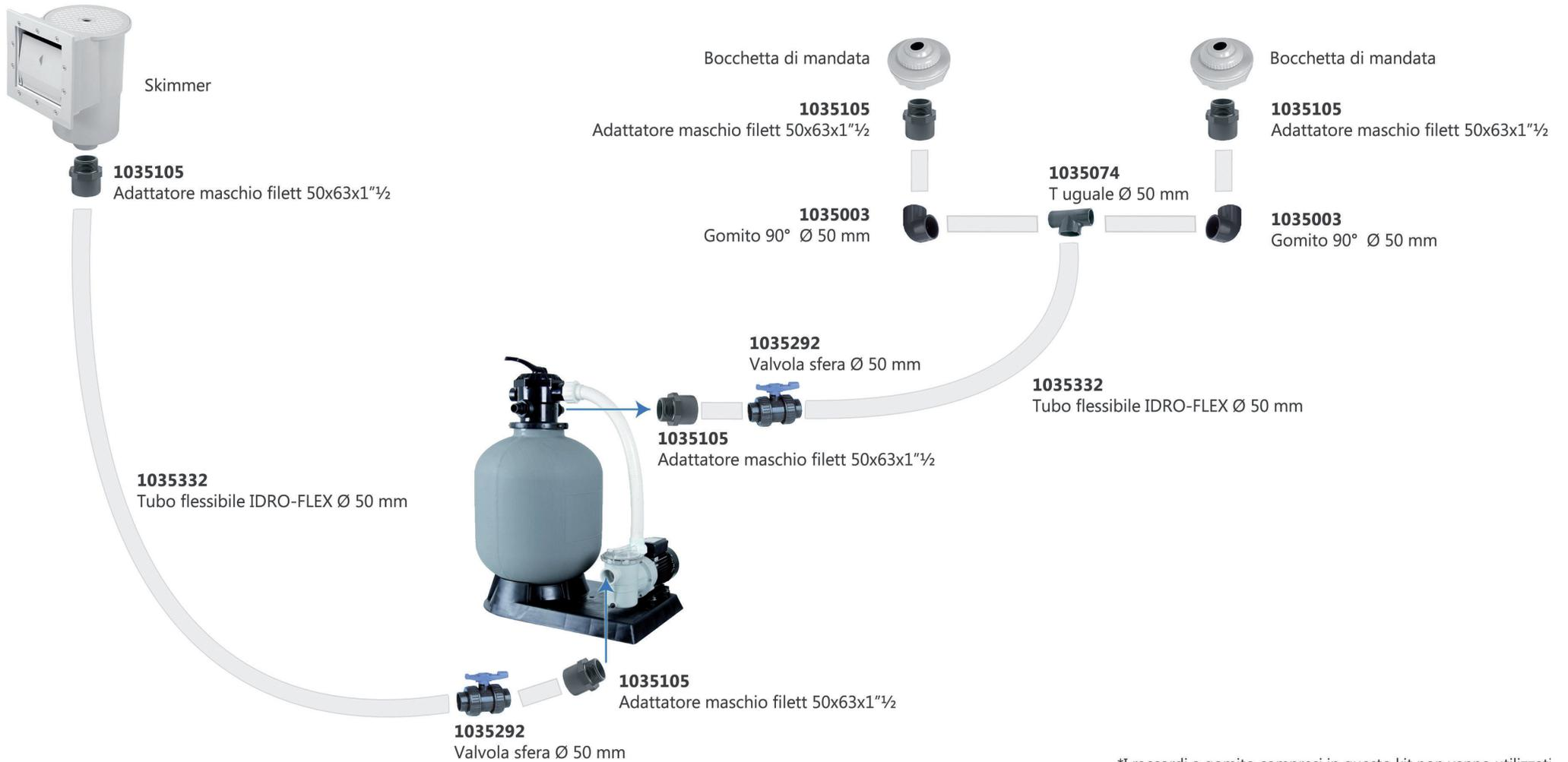
\*I raccordi a gomito compresi in questo kit non vanno utilizzati
