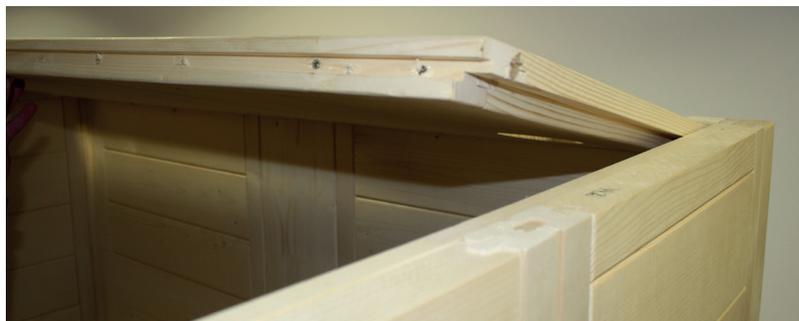
**Fig. 18: Inserimento dell'elemento tetto anteriore**
